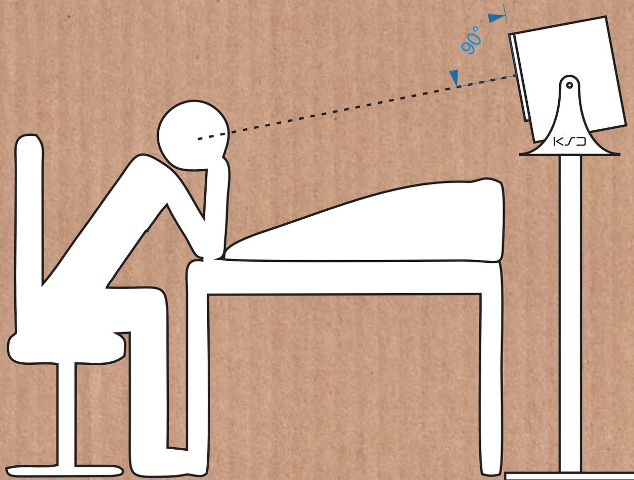
**// Aufstellungsguide:** Benutzen Sie den mitgelieferten Stand zur leichten Montage an der Wand oder bei Meterbridge-Aufstellungen zur Anwinkelung auf die Abhörposition. Das Koax-Prinzip erlaubt eine Drehung der Lautsprecher um die Mittelachse (Hochformat oder Querformataufstellung).
