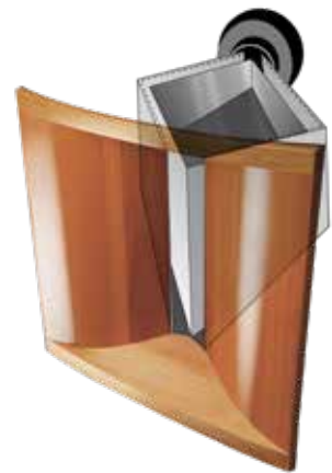
Schematische Darstellung des KS Digital-Schlitzstrahlers bestehend aus Treiber, Adapter und Schallführung
